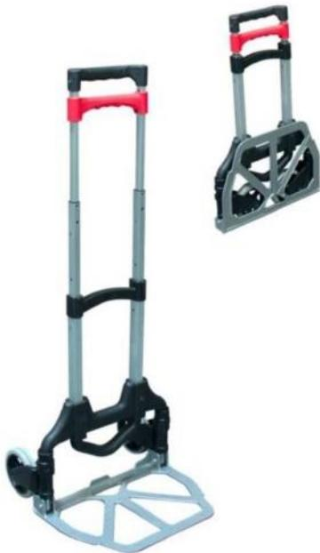
Diables à bavette et poignée repliables. Conçus pour une utilisation occasionnelle. Ultra légers. Poignée confortable soft touch. Compactable par emboîtement télescopique des tubes par action d'un bouton sur la poignée et par rétraction de la bavette et des roues coordonnées par un système de came progressive. Roues à structure aluminium, non tachantes avec double roulements. Livrés montés. Garantie 2ans.
