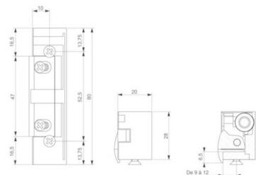
Pose réversible. Paramétrable à émission ou à rupture de courant. Entraxe de fixation standard 52,3 mm. Demi-tour réglable sur 3 mm.
