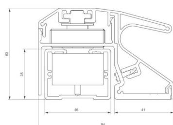
Concept tri-sectionnel : temps de pose réduit / structure renforcée (rigidité accrue). Bandeau résistant en aluminium anodisé naturel. Mode de fonctionnement à rupture de courant. IP54.
