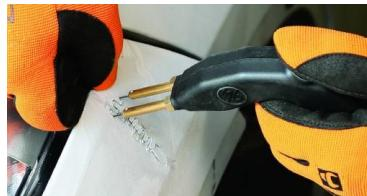
Permet de réparer rapidement les fissures et les ruptures de pièces en plastique. Câble pistolet thermique de 3,5 m. Pistolet thermique avec bouts en cuivre à 2 angles d'introduction de l'agrafe : 0°-90°. Protection input : disjoncteur thermique. Protection output : fusible 10 A. Gaine métallique pour ranger le pistolet.
