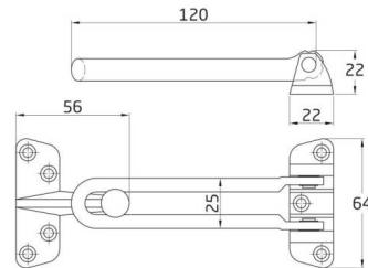
Le bloqueur de porte est fabriqué en alliage de zinc solide de haute qualité. La surface est polie. La plaque inférieure épaisse et le matériau épais de la tête de la serrure sont solides, ne se cassent pas facilement et sont plus sûrs, ce qui garantit la sécurité. L'arbre rotatif est équipé de billes d'acier de précision, la position du troisième engrenage est réglable et le bloqueur de porte s'ouvre et se ferme plus facilement.
