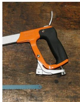
Monture de scie à métaux avec système de tension de la lame à déclenchement. Structure robuste pour une meilleure stabilité. Branche antidérapante. Déclenchement rapide de la lame à levier. Lame inclinable à 45°. Design ergonomique. Livré avec une lame montée.
