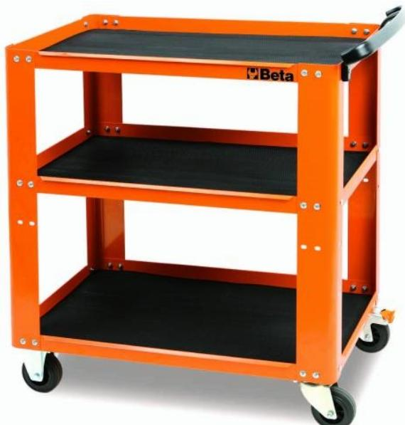
3 plateaux revêtus de caoutchouc antidérapant. Poignée ergonomique. Double possibilité de fixation du plateau central. 4 roues Ø 100 mm : 2 fixes et 2 pivotantes (dont une avec frein). Capacité de charge statique : 200 kg (répartie sur les 3 étagères).
