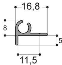
Support aluminium anodisé pour profilés anti-pince doigts D69 40 et D69 50. Idéal pour portes et fenêtres, bois, PVC, aluminium, côté serrure, vous permet de respecter la sécurité des lieux publics, écoles maternelles. En neuf ou rénovation.
