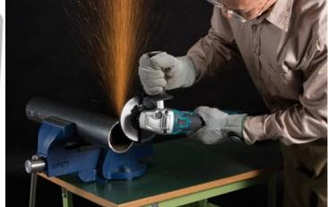
Grande performance grâce à son moteur sans charbon et sécurité optimale. Puissante, performante, maniable, compact et léger. Protection anti retour kick-back : le moteur se met en sécurité s'il détecte une chute brutale de la vitesse. Frein électrique et système anti-redémarrage pour plus de sécurité. Contrôle automatique de la vitesse en fonction de la charge appliquée assurant un meulage optimal.
