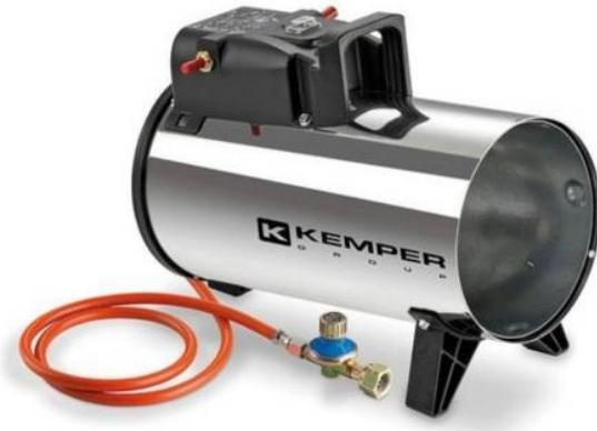
Générateur d'air chaud fonctionnant au gaz butane/propane avec ventilateur électrique intégré. Contrôle de la flamme avec thermocouple et vanne de gaz. Modèle avec allumage manuel avec système piézoélectrique. Fabriqué en acier inoxydable. Équipé d'un thermostat de sécurité.
