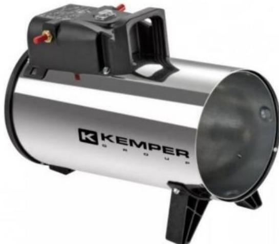
Fabriqué en acier inoxydable, avec allumage piézoélectrique ; Il est idéal pour fournir de la chaleur rapidement et économiquement aux chantiers de construction, aux serres, aux fermes. Idéal pour le séchage et la décongélation. Contrôle de la flamme avec thermocouple et vanne de gaz ; thermostat de sécurité. Câble d'alimentation, tuyau de gaz et régulateur de pression inclus.
