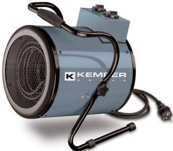
Générateur d'air chaud électrique portable. En acier peint. 3 niveaux de puissance (ventilation d'été/1500W/3000W). Niveau de protection IPX4. Résistance en acier inoxydable à haute efficacité. Poignée de transport. Thermostat ambiant réglable. Moteur avec protection thermique. Thermostat de sécurité anti-surchauffe. Mouvement de l'air environ 400m<sup>3</sup>/h
