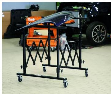
4 roues pivotantes dont 2 équipées de frein. Blocage des positions. Surface d'appui revêtue de caoutchouc amovible.
