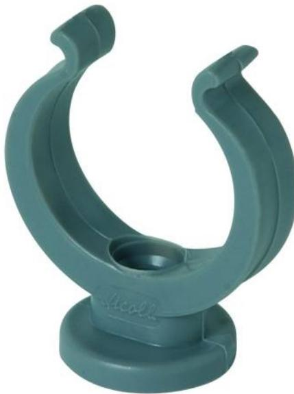
Amortissement des bruits. Attache de sécurité pour le maintien du tube. Fixation avec vis ou patte à vis. Embase de 12mm d'épaisseur au pas de 7/150.
