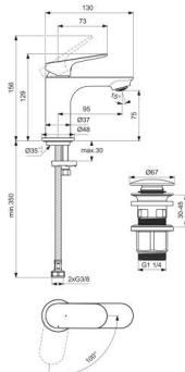
Mitigeur de lavabo piccolo Technologie Bluestart, cartouche Firmaflow 28 mm, 5 l/min pour 3 bar, bonde clic-clac chromé, hauteur sous aérateur 75mm, 95mm projection.
