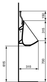
Urinoir 290x315x550 mm sans bonde en porcelaine vitrifiée avec alimentation apparente avec buse et tube. Fixation incluse pour une installation facilitée. Idéal pour les collectivités.
