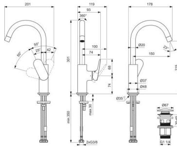
Mitigeur de lavabo Technologie Bluestart, cartouche Firmaflow 28 mm, 5 l/min, bonde clic clac chromé, hauteur sous aérateur 215 mm, 150 mm projection. Produit un jet d'eau non aéré et délivre un jet cristallin et sans éclaboussures, Pour une esthétique améliorée, Cartouche d'une grande durabilité >500 000 cycles d'utilisation., Chrome de qualité résistant aux rayures et plus facile à nettoyer.
