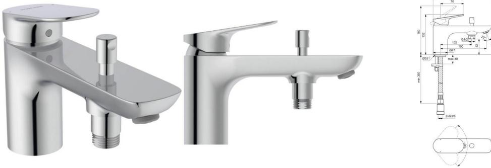
Mitigeur bain-douche monotrou, Click technologie : point dur débrayable à 50% du débit, cartouche Firmaflow+38 mm, 12 l/min, inverseur à retour automatique. NNotre système EasyFix réduit le temps d'installation jusqu'à 30 %., Cartouche d'une grande durabilité >500 000 cycles d'utilisation., Chrome de qualité résistant aux rayures et plus facile à nettoyer.
