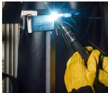
OK Autrod 4043 est un fil Al5Si destinée au soudage des alliages AISi et AIMgSi dont la teneur en Si peut atteindre 7%. Les pièces à souder ou le fil doivent être aussi propres que possible car la graisse, l'humidité, même en faible quantité, peuvent donner naissance à des défauts dans les soudures.
