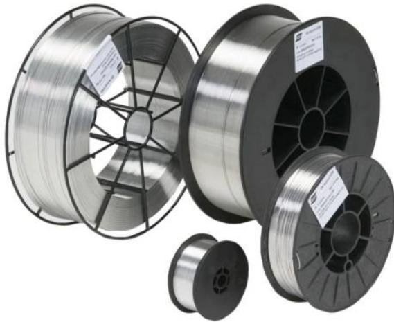
OK Autrod/Tigrod 316LSi est un fil à très bas carbone destiné au soudage MIG/TIG mécanisé des aciers austénitiques résistant à la corrosion à 18Cr12Ni3Motels que AISI 316 ou 316L ou légèrement moins alliés. Gaz de protection type: Ar+1 à 2% CO<sub>2</sub>.
