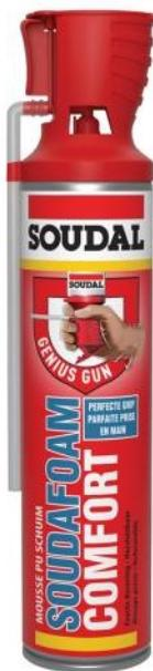
Mousse polyuréthane monocomposante, auto-expansive. Equipé du Genius Gun, pistolet intégré permettant un dosage précis, une facilité d'utilisation et une re-utilisation jusqu'à 6 semaines. Excellente adhérence sur tous supports, sauf PE/PP. Très bonne isolation thermique et acoustique. Excellentes caractéristiques pour le montage. Ne résiste pas aux rayons UV.
