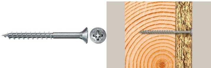
La vis à bois aggloméré fischer PowerFast II FPF II CZP BC est une vis zinguée blanc avec tête fraisée, à empreinte cruciforme PZ et à filetage partiel. La tête fraisée permet une installation affleurante dans le bois. La version avec filetage partiel permet de fixer solidement les éléments en bois entre eux. La vis convient pour les fixations dans le bois revêtu, le bois dur et le bois tendre ainsi que pour les assemblages en bois.
