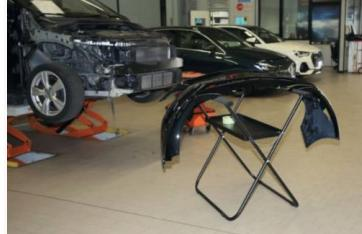
Surface d'appui revêtue de polyéthylène. Pliable.
