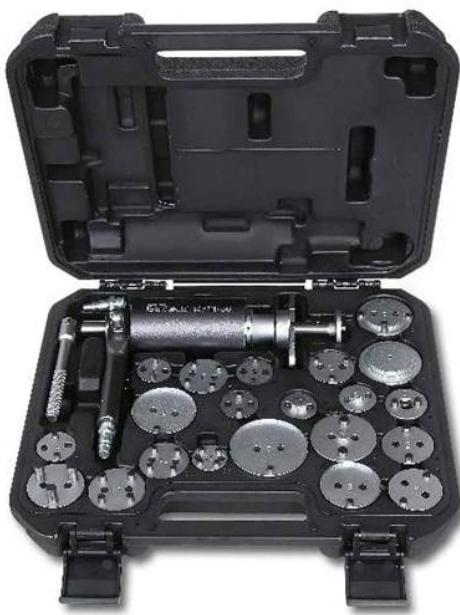
Outil pneumatique pour rétracter et faire tourner les pistons de frein à disque droit et gauche avec accessoires. Cric automatique. 150 kg de poussée. Pression de service 5-8 bar.
