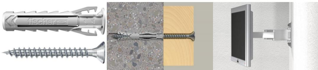
Quadruple expansion pour une charge optimale. Ailettes de maintien de la vis pour un montage facilité. La cheville s'intalle sans effort. La colerette empêche la cheville de glisser dans le forage. Couple de serrage perceptible.
