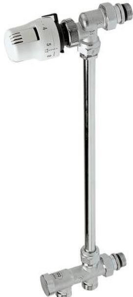
kit composé d'une tête thermostatique TTC, d'un corps thermostatique équerre inversé CT15EI, d'une canne laiton chromée 900mm Ø15mm, ZTA900, d'un répartiteur monotube sortie sol, raccords à compression RETM et de 2 raccord bicône pour tube de cuivre Ø 15mm.
