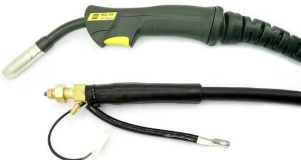
Torches de soudage refroidies par air. Poignées ergonomiques. Un refroidissement optimal des torches de soudage augmente la durée de vie du col de la torche et des pièces soumises à la chaleur. Un contact à ressort maintient le connecteur dans la douille centrale. Ø fil alimentation acier au carbone / acier inoxydable / poudre : 0,6-1 / 0,6-1 / 0,8
