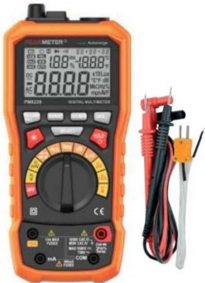
Multimètre, ampèremètre, ohmmètre, capacimètre, fréquencemètre, luxmètre, Humidimètre, Thermomètre, Décibelmètre. Sélection automatique du calibre de mesure. Affichage LCD rétro-éclairé. Capteurs en façade. Arrêt auto, hold. Test de diodes, de continuité. Livré en étui avec cordons de mesure et sonde type K.
