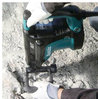
Système anti-vibration (technologie AVT + poignée). Soft No Load : le moteur ralentit hors charge = plus de précision, moins de vibrations et pas de frappe à vide. 12 positions de burin. Réglage électronique de la fréquence de frappe (5 plages). Ergonomie Soft Grip pour une meilleure prise en main.
