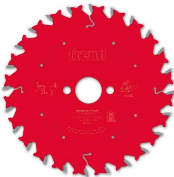
Lame pour scies circulaires portatives et scies circulaires plongeantes. Denture ATB avec angle d'attaque positif. Idéal pour bois massifs tendres et durs, panneaux agglomérés, contreplaqué, MDF et autres matériaux à base de bois.
