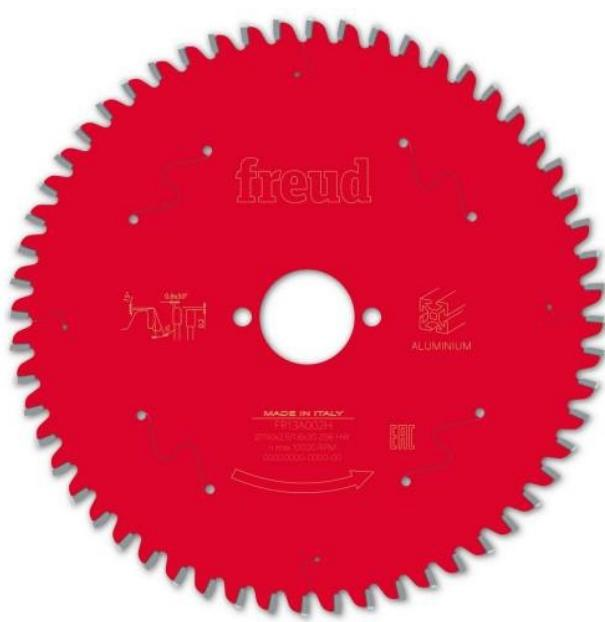
Pour scies circulaires portatives et scies plongeantes. Denture HLTCG avec angle d'attaque négatif. Idéale pour aluminium, autres métaux non ferreux et plastiques. Convient aussi pour les panneaux agglomérés et MDF.
