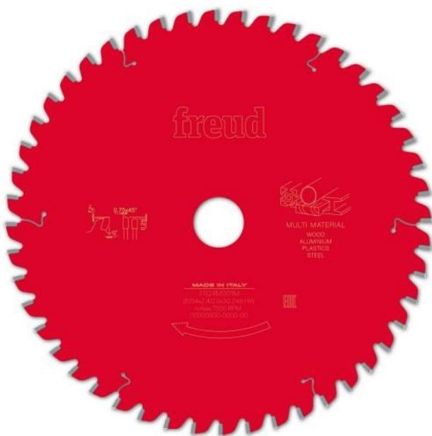
Pour scies à onglets. Lames conçues pour couper une grande variété de matériaux. Denture HLTG avec chanfrein aussi sur la deuxième dent. Angle d'attaque de 0°. Idéale pour matériaux à base de bois, aluminium et autres matériaux non ferreux, plastiques et profilés d'acier à paroi mince.
