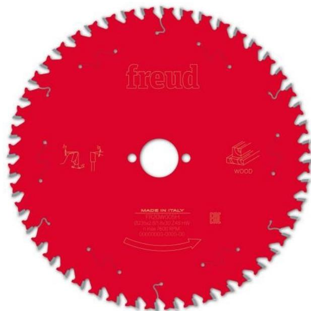
Pour scies circulaires portatives et scies circulaires plongeantes. Denture ATB avec angle d'attaque positif. Idéale pour bois massifs tendres et durs, panneaux agglomérés, contreplaqué, MDF et autres matériaux à base de bois.
