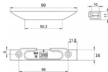
Gâche pour galets pour crémone T 16 mm décalée de 1 mm ou T 18 sans décalage. Jeu de 4 mm. A toupiller par fraise Ø330 mm. Tête de axe 9 mm. En acier traité FerGUardargent.
