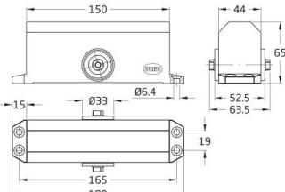
Ferme-porte multiforce réglable (2, 3, 4) lors du montage. Plaques pour portes en aluminium disponibles et vitesse de fermeture réglable. Notice de mise en pose incluse.
