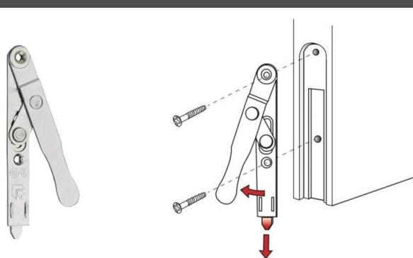
Utilisable pour menuiserie oscillo-battante bois (à entailler) ou PVC (à poser en rainure). Manoeuvre de condamnation par descente du pêne par basculement du levier. Pour jeu de feuillure 4 ou 12 mm. Tringle : 8,5x2,5 mm. Course : 15mm.
