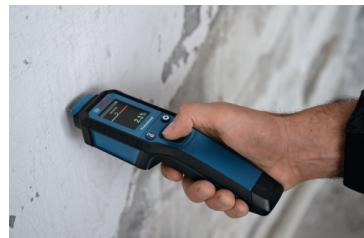
Humidimètre robuste pour des lectures rapides et précises sur un écran LCD couleur à contraste élevé. Autotest automatique avant chaque utilisation pour garantir une bonne précision des résultats. Ecran LCD TFT 2". IP65. Résolution de l'écran : 240x320 pixels
