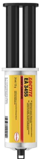
Résine époxyde à deux composants, enrichie en poudre d'aluminium. Il est spécialement conçu pour le collage et la réparation de pièces en aluminium ou en alliage léger. Ce produit polymérise à température ambiante et peut être sablé, usiné ou percé après application.
