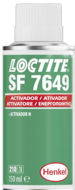
Activateur utilisé lorsqu'il est nécessaire d'accélérer la vitesse de polymérisation des produits LOCTITE® anaérobie. Ceci est particulièrement recommandé pour les applications sur métaux passifs, surfaces peu actives, ou avec des jeux importants. Il est aussi fortement recommandé lorsque la température ambiante de mise en oeuvre de l'adhésif est inférieure à 15 °C. Sel de Cuivre/ Amine aliphatique avec acétone. Liquide transparent vert clair à très faible viscosité.
