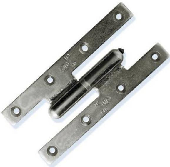
Paumelle picarde homologuée AFNOR et admise aux marques NF et CE. Les branches de la paumelle sont fraîsées en biseau. La rotation s'effectue sur une bague en laiton décolleté ou en option sur une butée à bille. Les nœuds sont équipés d'un système breveté, avec un bouchon obturateur, permettant le graissage sans démonter la porte.
