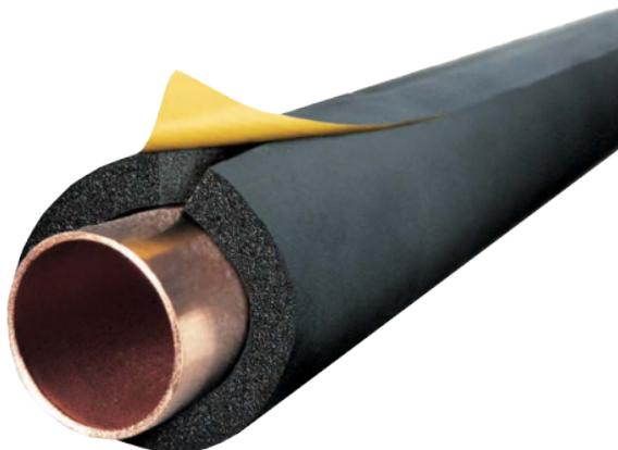
Isolant pour tuyauterie. Isolant à cellules fermées très flexible, possédant une grande résistance à la diffusion de la vapeur d'eau et une faible conductivité thermique. Mousse élastomère flexible à base de caoutchouc synthétique. Contrôle fiable de la condensation. Réduction efficace des pertes thermiques. Gamme optimale pour une application facile sur la plupart des tuyaux et conduits de différentes tailles.
