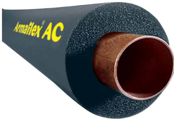
Isolant pour tuyauterie. Isolant à cellules fermées très flexible, possédant une grande résistance à la diffusion de la vapeur d'eau et une faible conductivité thermique. Mousse élastomère flexible à base de caoutchouc synthétique. Contrôle fiable de la condensation. Réduction efficace des pertes thermiques. Gamme optimale pour une application facile sur la plupart des tuyaux et conduits de différentes tailles.
