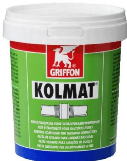
Pour étancher des raccords filetés métalliques, par exemple dans des systèmes à l'eau, au gaz (installations de CC) et à l'air comprimé. Utiliser en combinaison avec de la filasse. Convient à des systèmes de gaz de -20°C jusqu'à +70°C, pression max. 5 bars. Convient à des systèmes d'eau jusqu'à 95°C avec pression max. 16 bars. Convient à des systèmes de vapeur (d'eau) jusqu'à +130°C, pression max. 7 bars.
