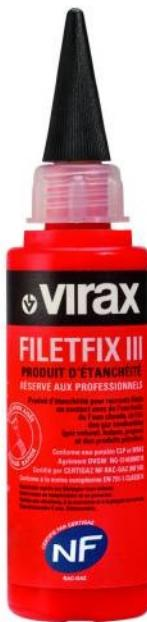
Haute tenue en température et en pression, résiste aux vibrations, à la corrosion et à la plupart des solvants. Repositionnable avant séchage. Ne pas utiliser sur des circuits d'oxygène pur ou de vapeur, ni sur les plastiques. EN 751-1 Classe H. Agrément eau potable WRAS et DVGW (NG-5146BN0170).
