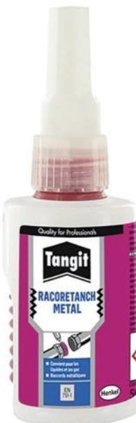
Raccords filetés métalliques jusqu'à 1 pouce et demi entre canalisations, vannes, unions, coudes, manomètres... S'applique sur : acier, cuivre, laiton, bronze, nickel, fonte, aluminium sans besoin d'activateur. Etanchéité immédiate à 30 bars, démontable avec les outils habituels, repositionnable dans les 5 minutes.
