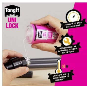
Fil de nylon pour raccords filetés métalliques : acier, inox, cuivre, laiton, fonte, aluminium..., raccords filetés plastiques : PVC-U, PVC-C, PP, PE, réseaux de fluides (eau froide et chaude jusqu'à 130°C) et de gaz : air comprimé, gaz de ville, butane, propane... (Sauf hydrocarbures et oxygène). Mise en pression immédiatement (jusqu'à 7 bars pour l'eau, 16 bars pour le gaz).
