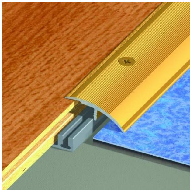
Ce profilé à fixation simultanée permet la transition entre deux revêtements de hauteurs différentes et assure une dilatation libre des parquets. Différence de niveau 0 à 20mm.
