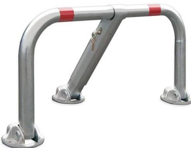
Barrière de Parking 3 pieds. Très belle réalisation, renforcée à arceau. Trois pieds articulés ,facilement manipulables. Sabots en acier. Demi cylindre européen 30X10 laiton nickelé « KLOSE « 3 clés. Tube Galvanisé à chaud pour une durabilité accrue. Diamètre de section : 50 mm. Montée et blocage automatique.
