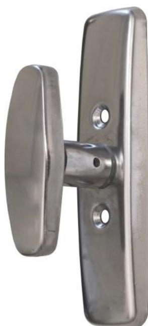
Bouton cache inox pour Map N°9. Entraxe de 43 mm. Livré avec vis TBF 5x12mm.
