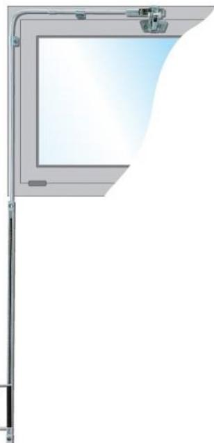
Ferme imposte à câble souple et poignée coulissante. Conçu pour actionner des châssis Abattant Intérieur jusqu'à 25 kg. Une poignée alu avec butée, une glissière de 600 mm en acier zingué, course réglable. Ouverture 500mm maximum. Tubes cintrables en acier zingué. Rayon de cintrage des tubes, à respecter 90 mm. Câble souple à longueur.
